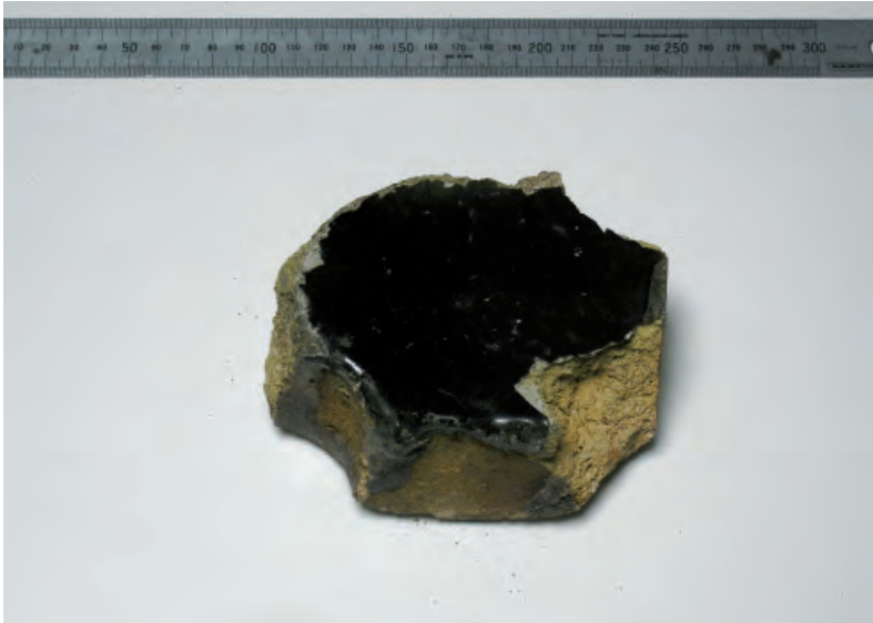
Afb. 12b. Bodemplaat met gesmolten glas en half rond gat links onder.
